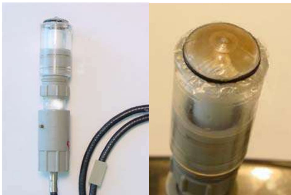
Рис.4 Внешний вид микробиологического биосенсора МББ-01.
